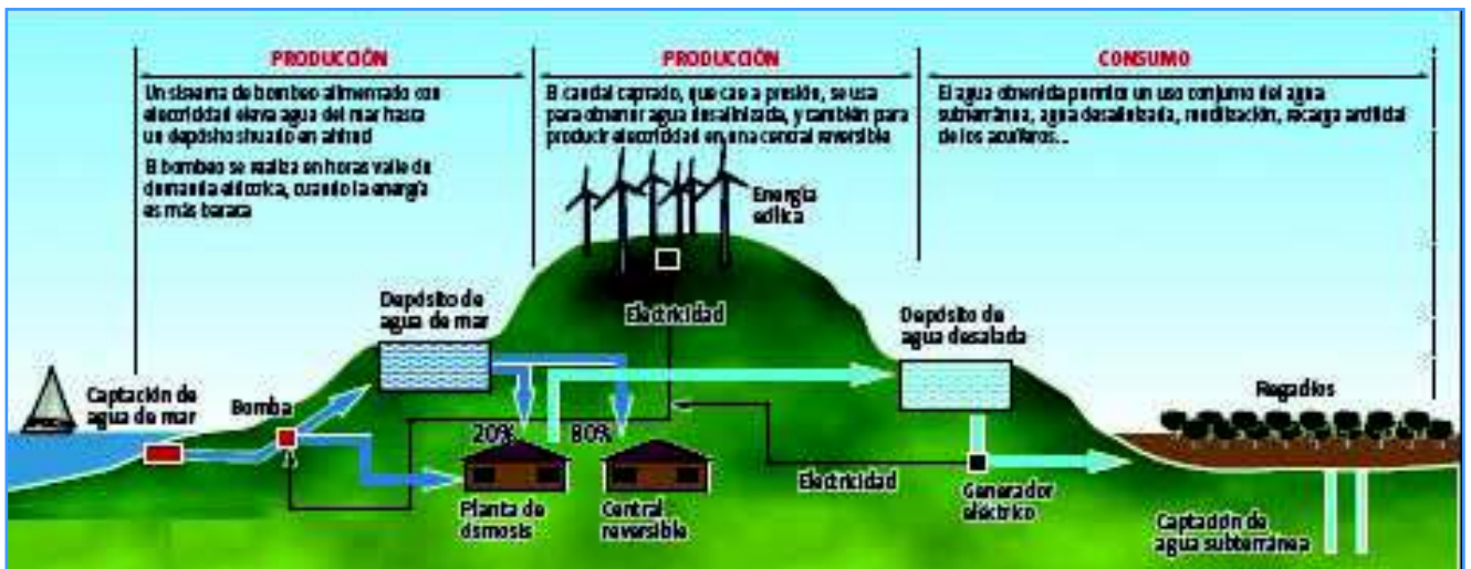
Esquema de aprovechamiento conjunto agua/energía
